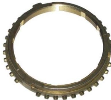
Gambar 2.7. *Sinkronizer ring / Singkromes*
