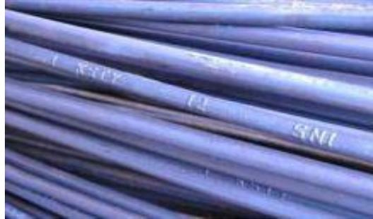
Gambar 2.2 Baja tulangan beton polos
