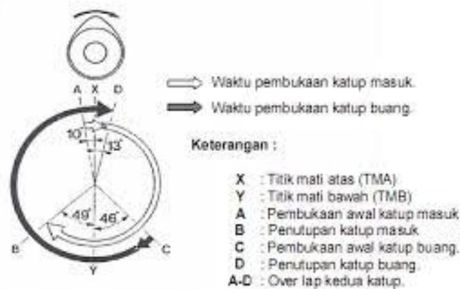
Gambar 2.9 Diagram Siklus Kerja Motor Diesel 4 Langkah
