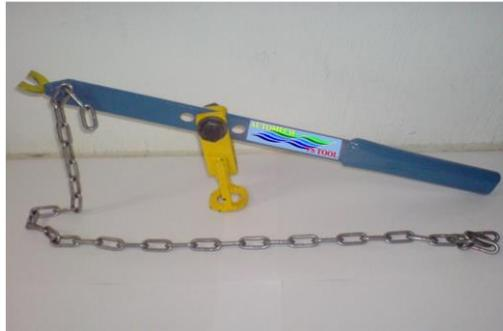
Gambar 2.29 Valve Spring Removal Special Tool yang telah ada / dipakai dibengkel perbaikan PT. United Tractors
