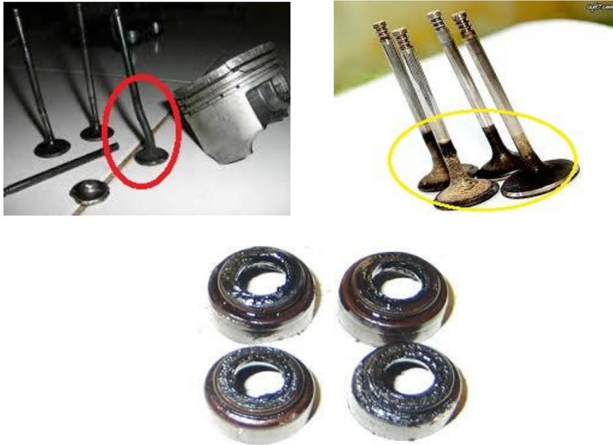
Gambar 2.28 Komponen-komponen katup yang rusak
