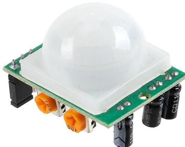
Gambar 2.4. Gambar Module sensor pir
