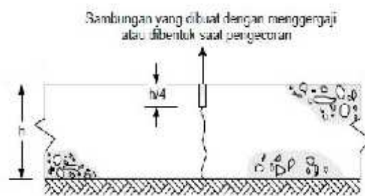
Gambar 2.30 Sambungan Susut Melintang Tanpa Ruji
