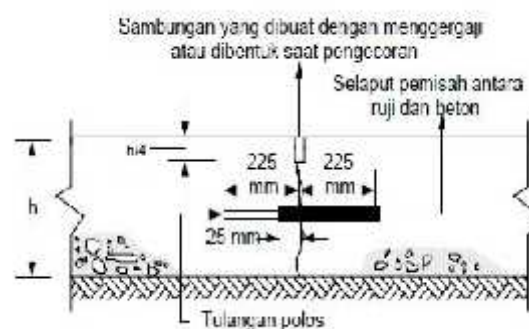
Gambar 2.31 Sambungan Susut Melintang dengan Ruji
