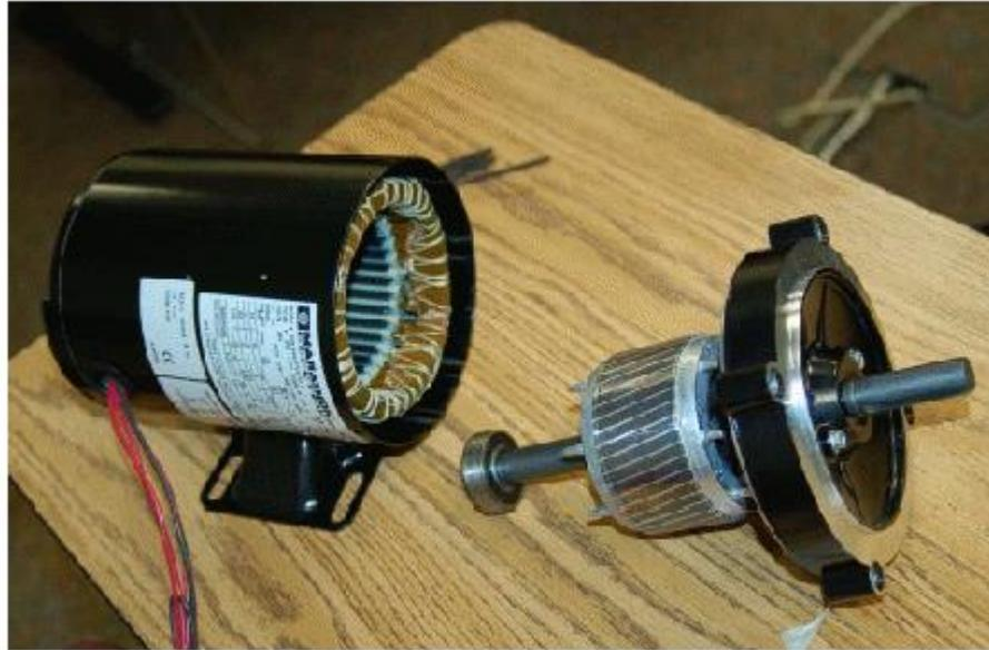
**Gambar 2.3 Motor Induksi Rotor Sangkar**
