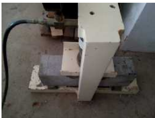
Gambar 20 : Pengujian sampel beton
