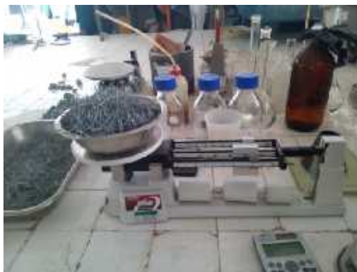
Gambar 14 : Penimbangan kawat yang digunakan sebagai campuran
