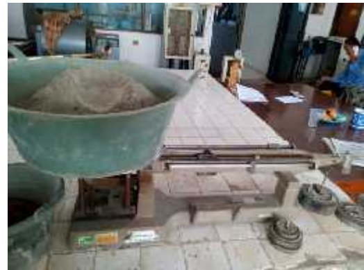
Gambar 13 : Penimbangan bahan yang digunakan untuk campuran beton
