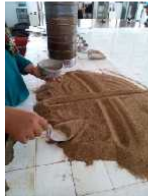
Gambar 8 : Pengambilan Sample Agregat Halus Untuk Pengujian Analisa Saringan
