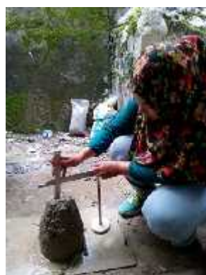
Gambar 16 : Pengujian slump test
