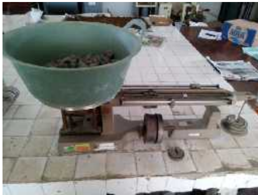
Gambar 13 : Penimbangan bahan yang digunakan untuk campuran beton
