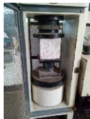
Gambar 20 : Pengujian sampel beton
