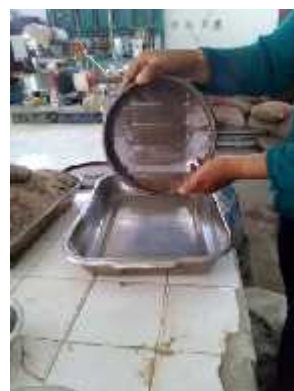
Gambar 9 : Pengujian Analisa Saringan Agregat Halus
