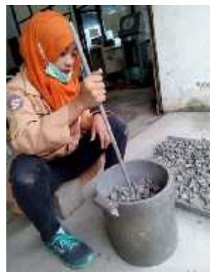
Gambar 3 : Pengujian Berat Isi Agregat Kasar
