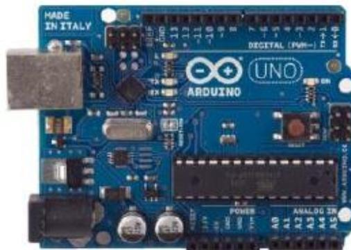
**Gambar 2.8** Bentuk Fisik Arduino Uno
