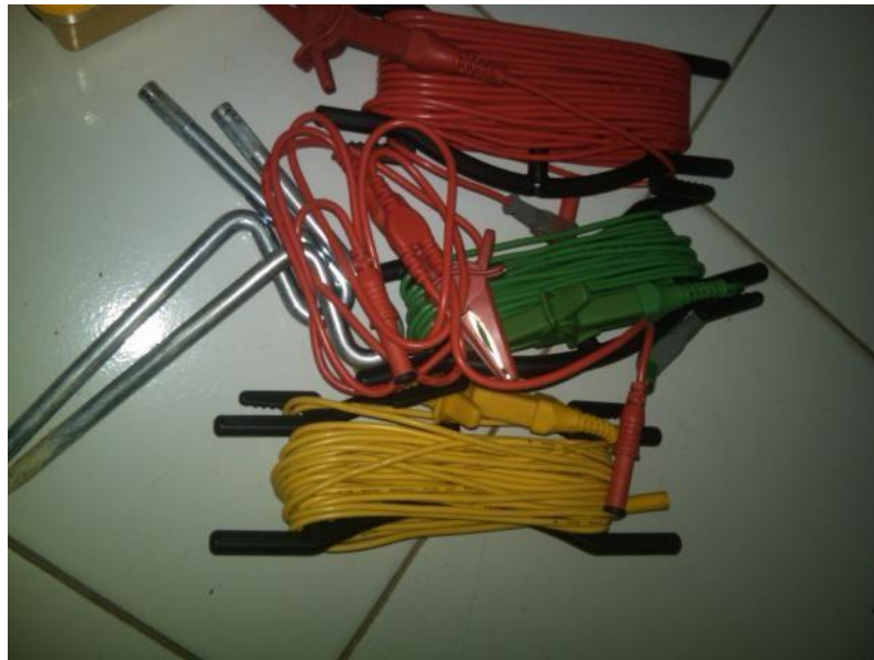
Gambar 2.20 Elektroda Bantu Dan Kabel yang Digunakan pada Pengukuran Nilai Tahanan Pentanahan
