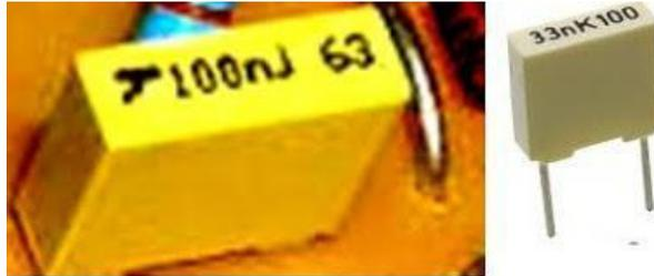
Gambar 2.24 Contoh kapasitor dengan penulisan kapasitansi menggunakan kode huruf dan angka<sup>1</sup>
