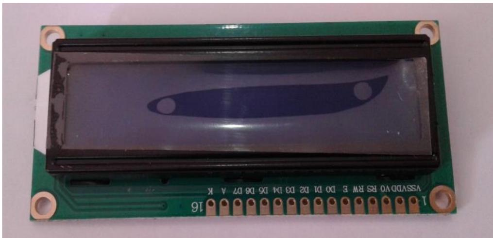
Gambar 2.14 LCD (16x2)
