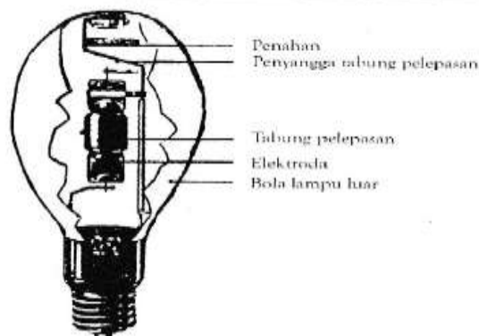
Gambar 2.8. Konstruksi lampu metal halida
