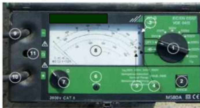
Gambar 2.4 Alat ukur mega Ohm meter<sup>7</sup>
