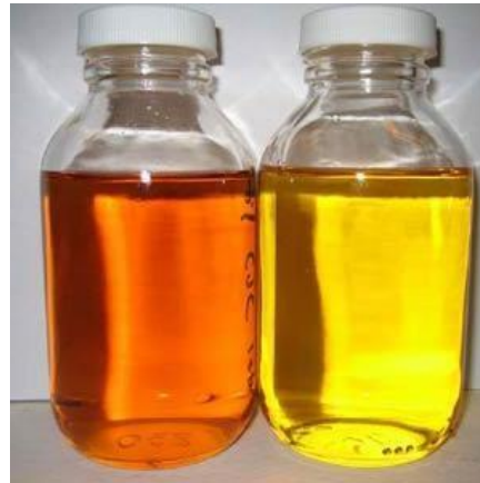
Gambar 2.14 Minyak isolasi trafo
