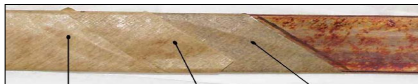
Gambar 2.15. Tembaga yang dilapisi kertas isolasi
