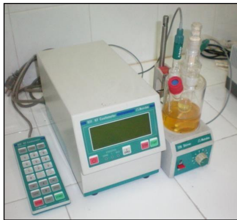
Gambar 2.22 Contoh alat uji kadar uji kadar air dalam minyak dengan metode Karl Fisher (KF)
