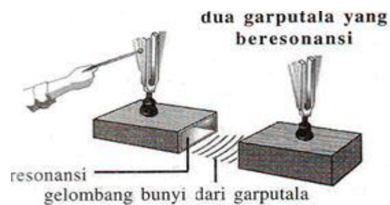
Gambar 2.6 Resonansi Pada Garpu Tala
