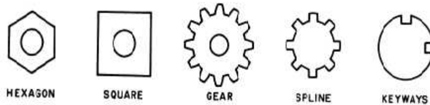
Gambar 2.8 Benda Kerja Yang Di Mesin Dengan Fixture Index
