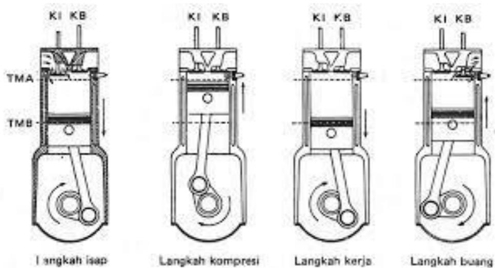
**Gambar 2.11 . Proses Kerja Motor 4 Langkah**
