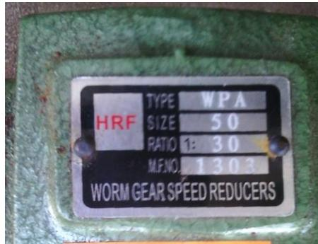
Gambar 2.3 : spesifikasi gear box
