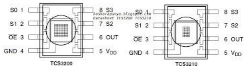
Gambar 2.10 Konfigurasi Pin TCS3200 dan TCS3210
