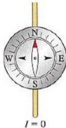
Gambar 2.5 (a) Percobaan Oestred Untuk Membuktikan GGL dapat Menimbulkan GGM (Sumber: http://lib.ui.ac.id/file?file=digital/20308233-S42660-Potensi%20medan.pdf diakses Selasa, 28 Juni 2016 pukul 08:45 WIB)
