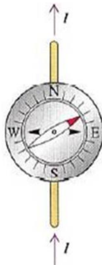
Gambar 2.5 (b) Percobaan Oestred Untuk Membuktikan GGL dapat Menimbulkan GGM (Sumber: http://lib.ui.ac.id/file?file=digital/20308233-S42660-Potensi%20medan.pdf diakses Selasa, 28 Juni 2016 pukul 08:45 WIB)
