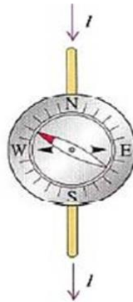
Gambar 2.5 (c) Percobaan Oestred Untuk Membuktikan GGL dapat Menimbulkan GGM (Sumber: http://lib.ui.ac.id/file?file=digital/20308233-S42660-Potensi%20medan.pdf diakses Selasa, 28 Juni 2016 pukul 08:45 WIB)
