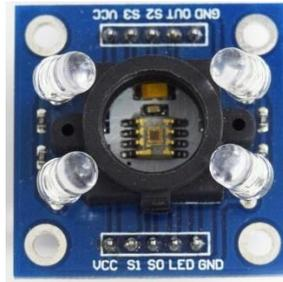
**Gambar 2.1 Sensor Warna TCS3200**
