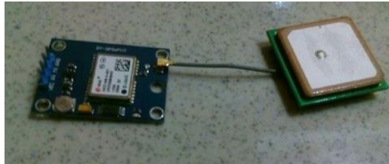
Gambar 2.17 Modul GPS APM2.5 Neo-6M (Sumber: Dokumentasi Penulis)
