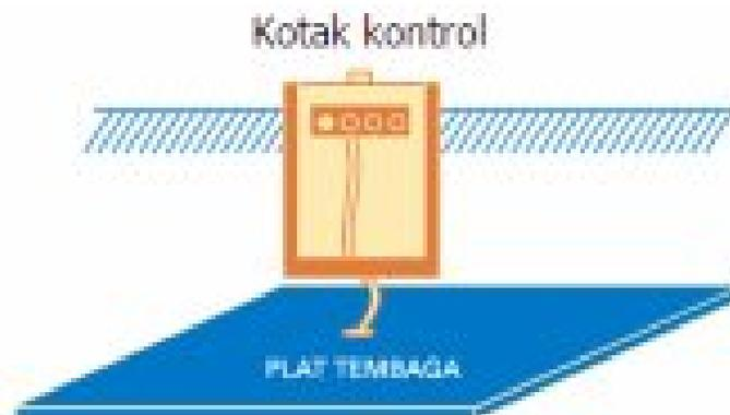
Gambar 2.6 Cara Penanaman Elektroda Plat
