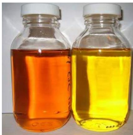
Gambar 2.7 Minyak Isolasi Transformator
