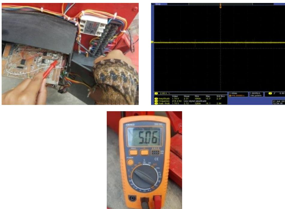
**Gambar 4.3.** Pengukuran Pada Vout IC 7805
