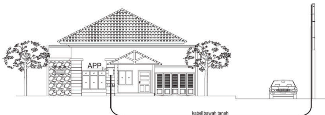
Gambar 2.7 Konstruksi Sambungan Tenaga Listrik Tipe E
