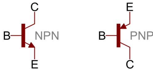
**Gambar 2.7 Skematik Transistor NPN dan PNP**
