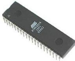
**Gambar 2.2 Bentuk Fisik AVR ATMEga16**
