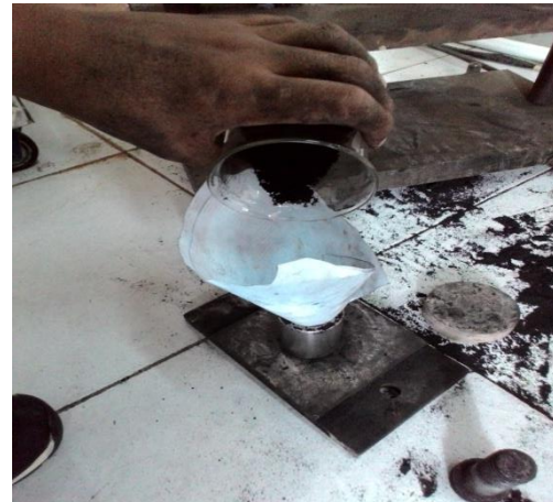
Gambar 36. Pencampuran Briket & Perekat
