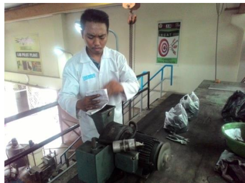
Gambar 26. Proses Penghalusan Arang
