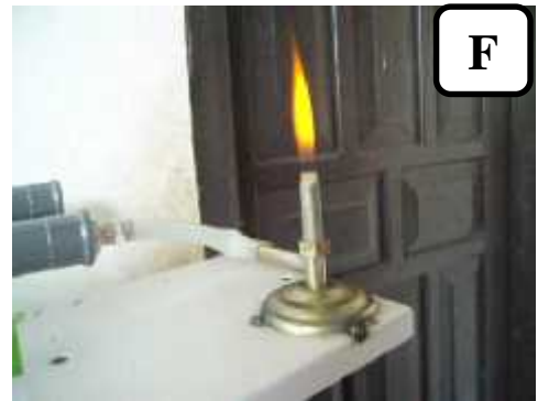
Gambar 21. A) Pencampuran Larutan NaCl dengan Bahan Baku Air 6 Liter, B) Memasukkan Bahan Baku ke dalam Alat Prototype Water Electrolyzer , C) Pengisian Tabung Penampung Gas Hidrogen dan Oksigen, D) Penampungan Produk Gas Hidrogen ke dalam Sampel Bag, E) Produk Gas Hidrogen, F) Nyala Api yang Dihasilkan pada Gas Hidrogen
