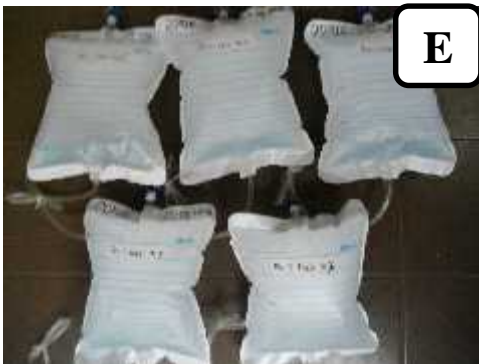
Gambar 21. A) Pencampuran Larutan NaCl dengan Bahan Baku Air 6 Liter, B) Memasukkan Bahan Baku ke dalam Alat Prototype Water Electrolyzer , C) Pengisian Tabung Penampung Gas Hidrogen dan Oksigen, D) Penampungan Produk Gas Hidrogen ke dalam Sampel Bag, E) Produk Gas Hidrogen, F) Nyala Api yang Dihasilkan pada Gas Hidrogen
