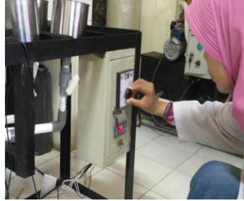
2. Menghidupkan pemanas dan mengatur suhu pada control panel
