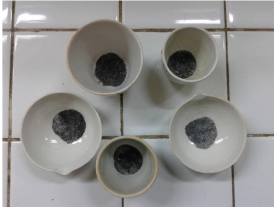
Gambar 40. Hasil Penentuan Kadar Zat Terbang
