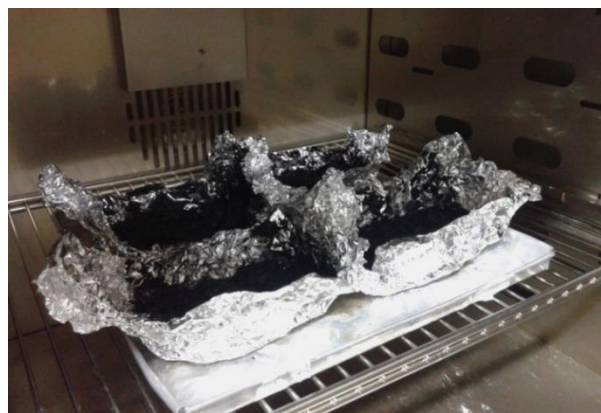
Gambar 33. Proses Pengeringan Karbon Aktif
