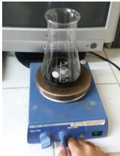
Gambar 44. Proses Perendaman Karbon Aktif dalam Larutan Ni
