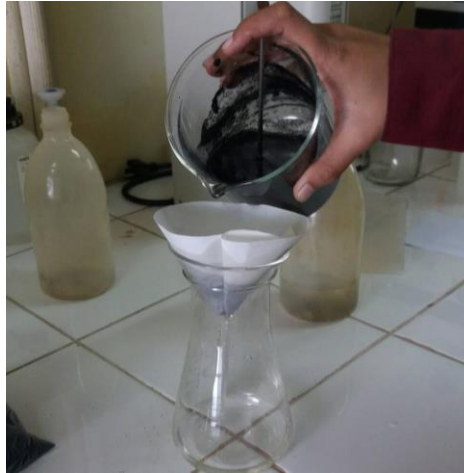
Gambar 31. Proses Penyaringan Karbon Aktif
