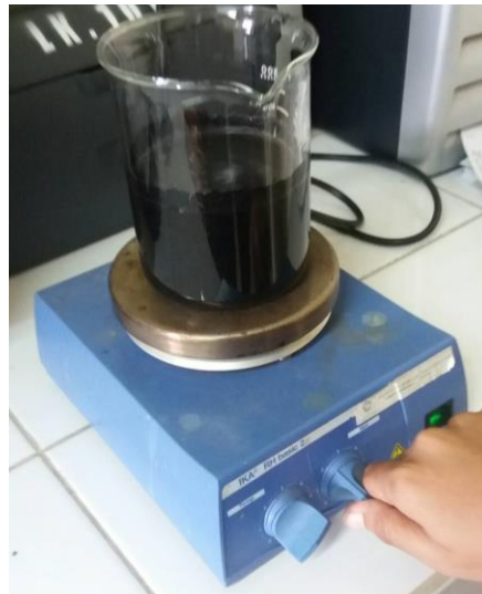
Gambar 29. Proses Pengadukan Arang dan Aktivator
