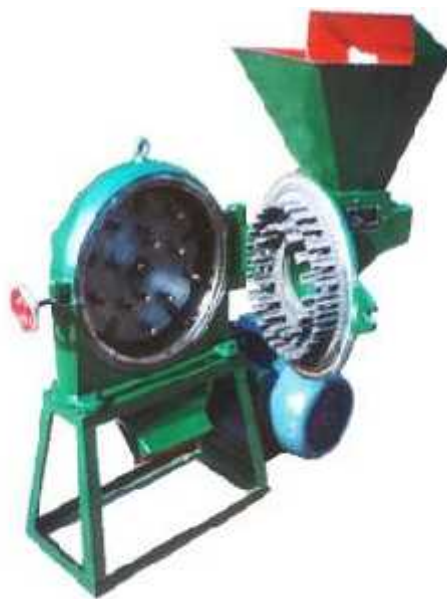
Gambar 6. Disc mill (sumber: http://www.google.co.id )
