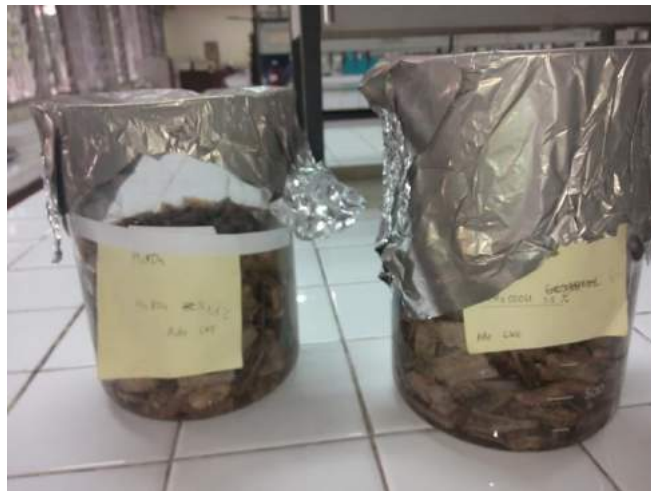
Gambar 12. Perendaman Tulang dengan Larutan HCl
