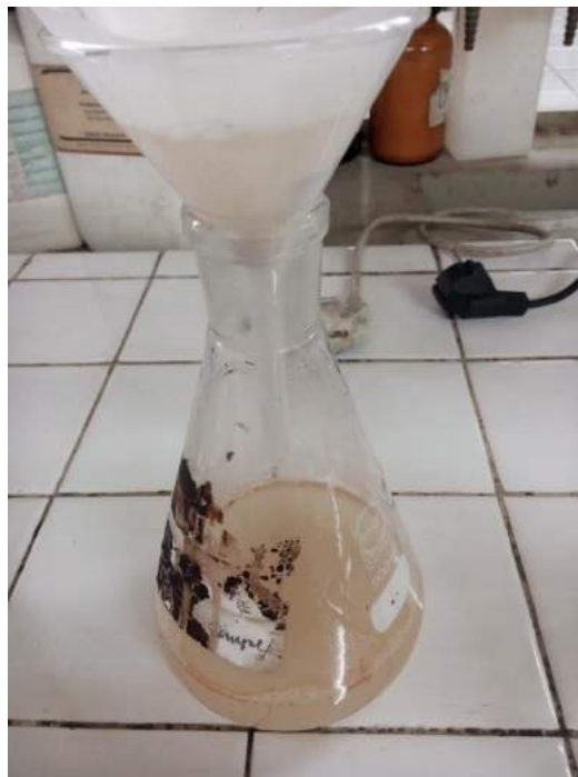
Gambar 14. Proses Penyaringan Cairan Gelatin
