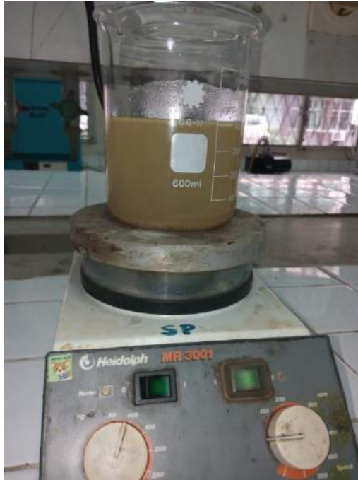
Gambar 15. Proses Pemekatan Cairan Gelatin Menjadi Lem
