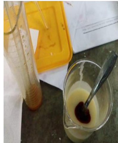
Setelah 45 menit sabun ditambahkan zat aditif berupa ekstrak kunyit yang telah dibuat
