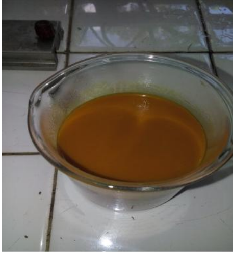
Ekstrak Kunyit diperoleh setelah dilakukan pemekatan dengan rotary evaporator
