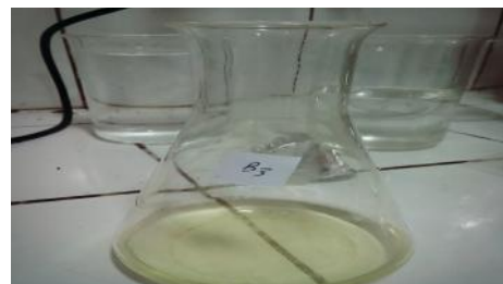
Pengujian Alkali Bebas Pada Sampel Sabun Padat
