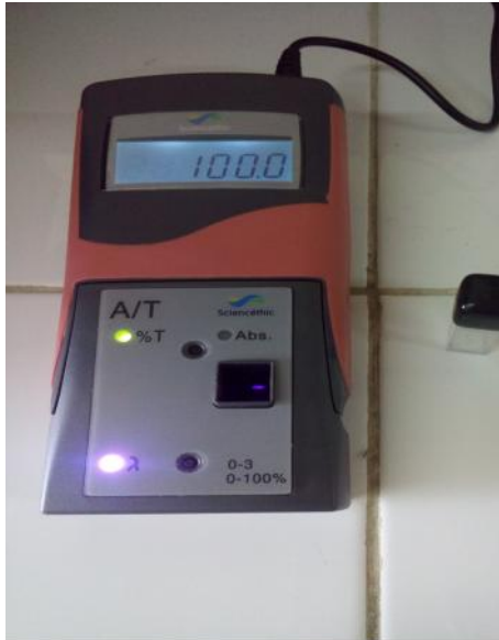
Analisa kadar Antioksidan dengan Colourimeter
