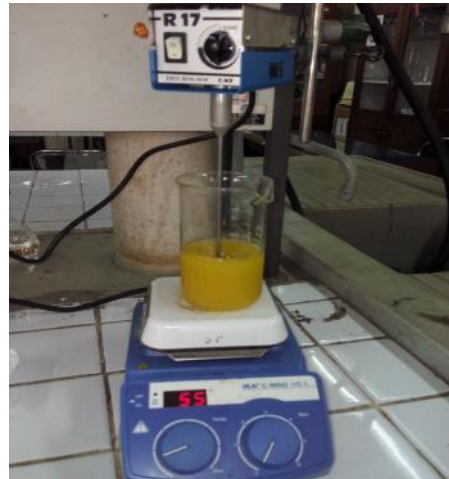
Minyak dipanaskan dengan hot plate sambil diaduk menggunakan pengaduk sampai suhu 55°C
