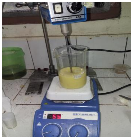
Setelah suhu minyak 55°C ditambahkan NaOH 30% dan diaduk selama 45 menit
