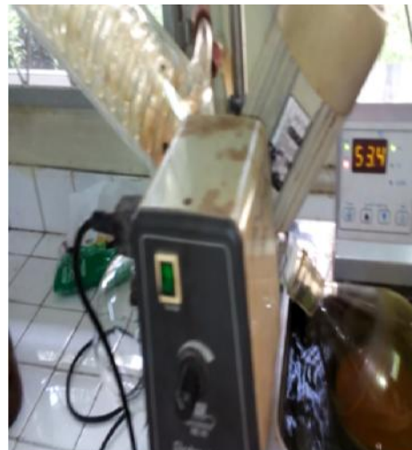
Kunyit yang telah dimaserasi dipekatkan dengan rotary evaporator
