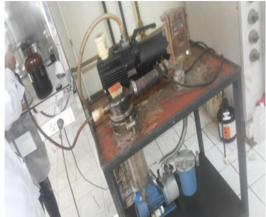
Gambar 24. Ekstrak difilter menggunakan vacuum rotary .
