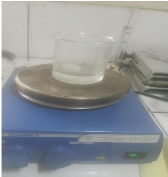
Gambar 30. Aquadest Panas dan Hydroxypropyl Methyl Cellulose sesuai dengan formula yang telah ditentukan
