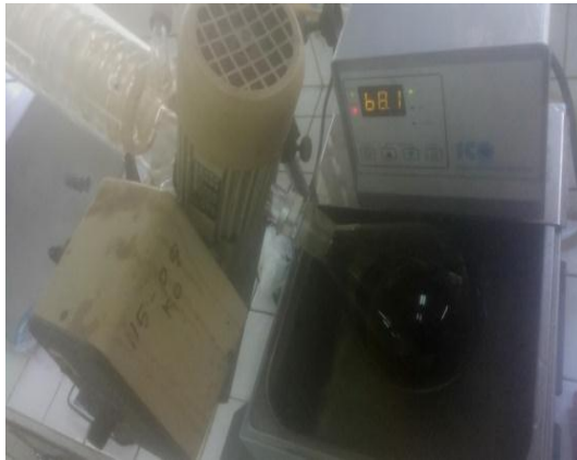
Gambar 25. Pelarut diuapkan menggunakan rotary evaporator .
