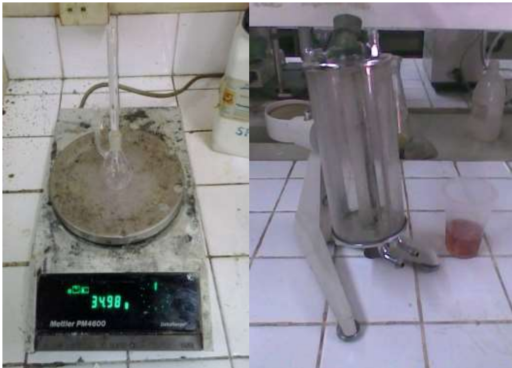
Gambar 23. Analisa Densitas dan Viskositas
