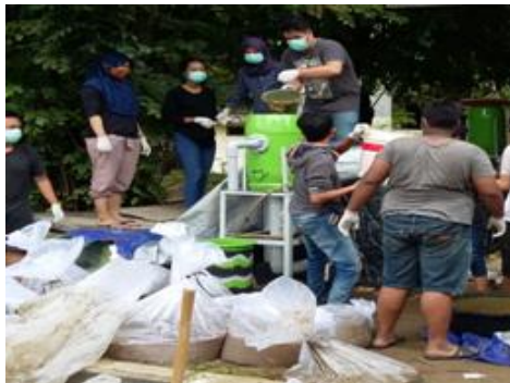
Gambar 28. Pemasukkan Bahan Baku Kedalam Digester
