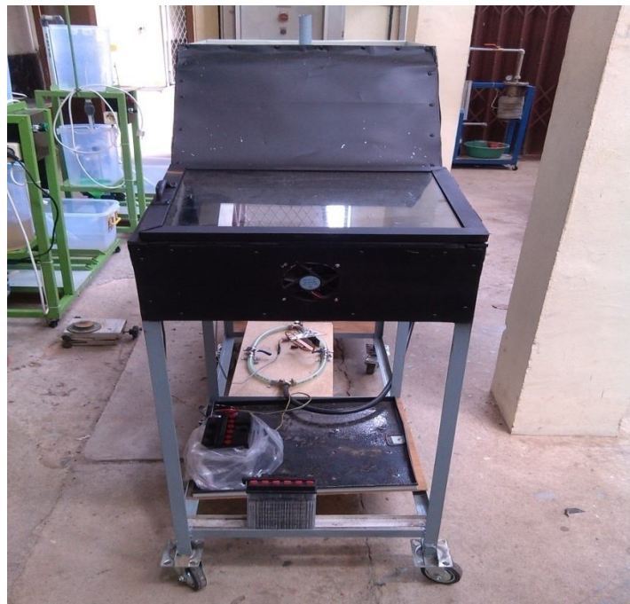
Gambar 26. Ruang pengering dan kolektor termal tampak belakang
