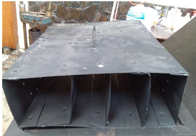
Gambar 28. Kolektor termal tampak samping
