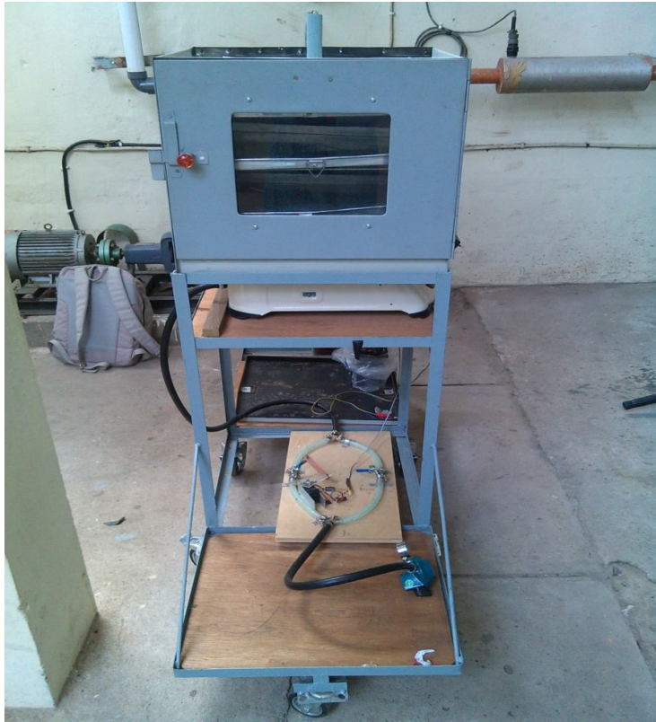
Gambar 25. Ruang pengering dan kolektor termal tampak depan
