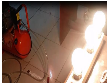
Gambar 33. Uji Nyala Genset
