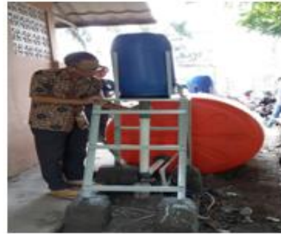
Gambar 23. Pengecekan Kebocoran Digester
