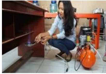
Gambar 31. Uji Nyala Biogas
