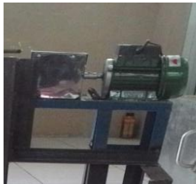
Hasil Pemasangan Pamarut ke rangka besi
