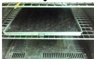
Pulp Dikeringkan di Oven dengan suhu 105 °Celcius
