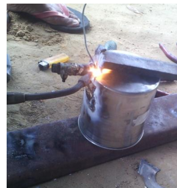
Menyatukan Valve dan Tempat Pelarut dengan Kuningan
