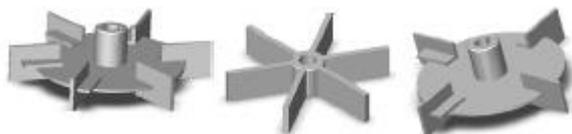
**Gambar 4.** Pengaduk Turbin pada Bagian Variasi
