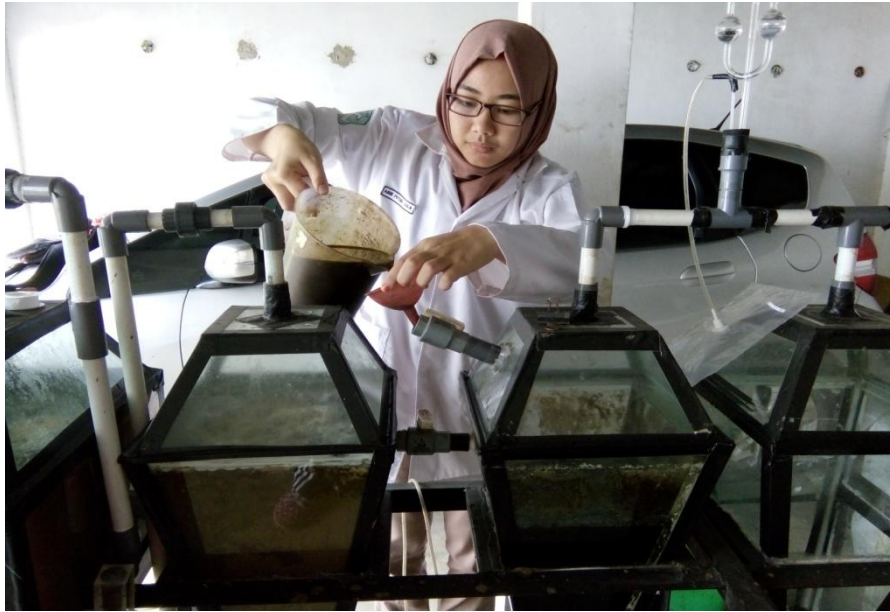
Proses penambahan umpan kedalam Tangki II yang dilakukan setiap hari
