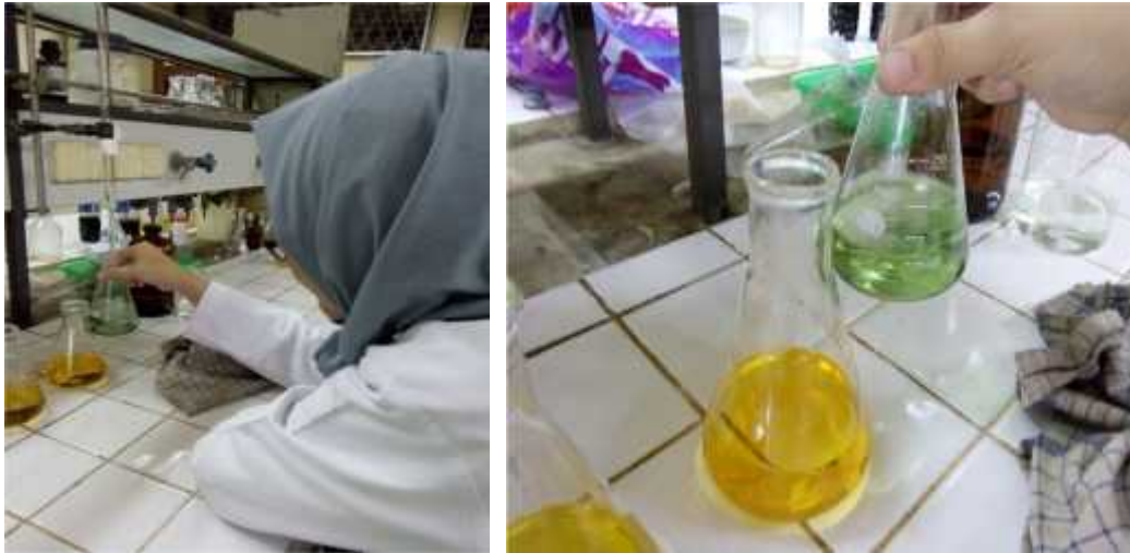
Gambar 25. Proses Standarisasi Larutan Gambar 26. Larutan FAS setelah di Titrasi
