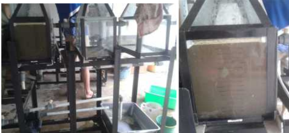
Gambar 19. Bahan baku yang telah dimasukkan pada Tangki 1 didiamkan untuk mengalami proses sedimentasi
