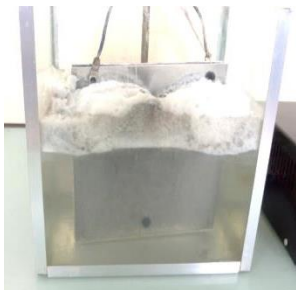
(f) Sampel Limbah Laundry setelah di Elektrokoagulasi selama 120 menit
