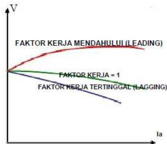
Gambar 2.8 kurva pengaturan generator AC pada faktor daya yang berbeda
