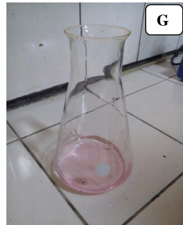
Gambar 12. A) Alat Desktruksi, B) Alat Distilasi, C) Proses Distilasi, D) Distilat, E) Pemberian Indikator pada Distilat, F) Distilat yang Sudah Diberi Indikator, G) Distilat yang Sudah Dititrasi dengan HCL 0,1 N
