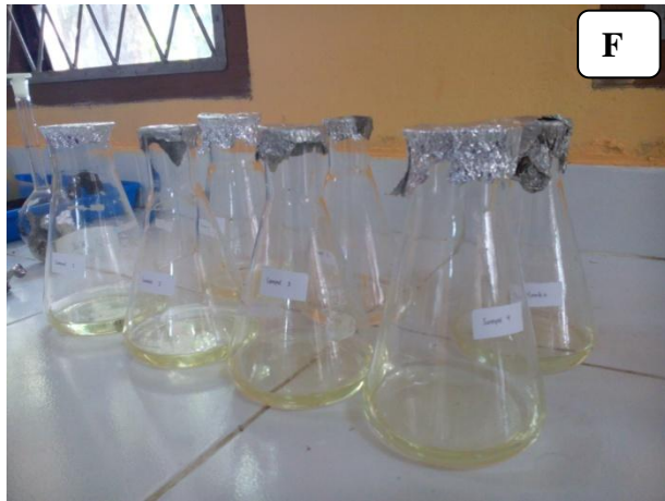
Gambar 12. A) Alat Desktruksi, B) Alat Distilasi, C) Proses Distilasi, D) Distilat, E) Pemberian Indikator pada Distilat, F) Distilat yang Sudah Diberi Indikator, G) Distilat yang Sudah Dititrasi dengan HCL 0,1 N
