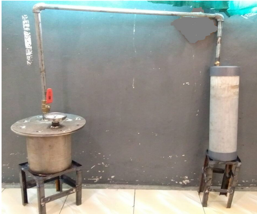
Seperangkat Alat Pirolisis Pembuatan Asap Cair
