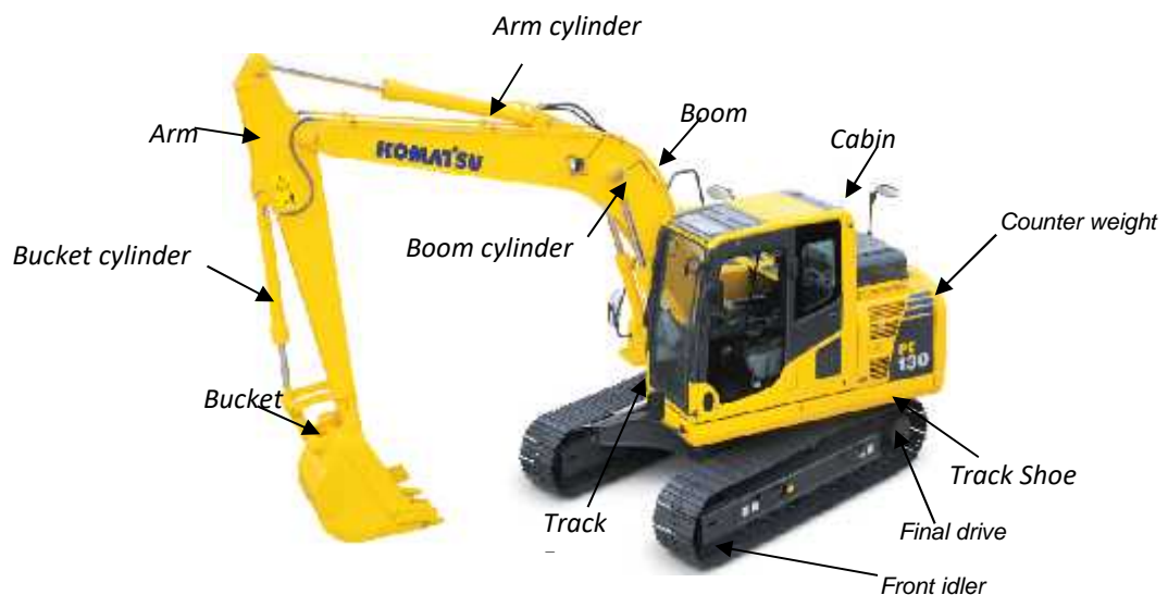
Gambar 2.2 Bagian-Bagian dari Excavator (Sumber: diolah)
