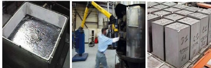
**Gambar 2.13 Metode Casting Pembuatan Bahan Polikristal**
