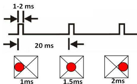
**Gambar 2.5** Bentuk sinyal *radio receiver* dan posisi *stick*.
