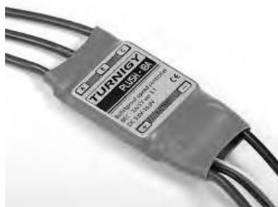
**Gambar 2.12** Contoh Bentuk Fisik ESC.
