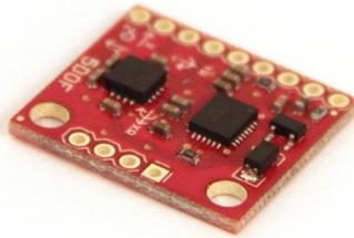
**Gambar 2.13** Accelerometer dan Gyroscope
